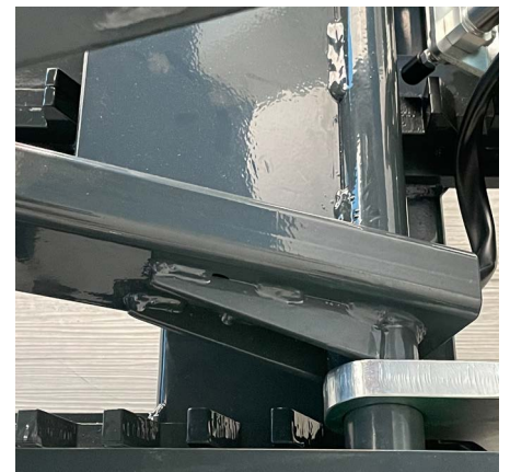
SICHERHEITS-KLINKE VERHINDERT UNGEWOLLTES ABSINKEN
