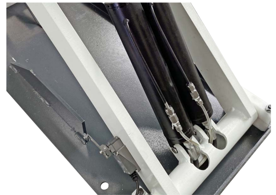
HYDRAULISCHE GLEICHLAUFREGULIERUNG DER FAHRSCIENEN
