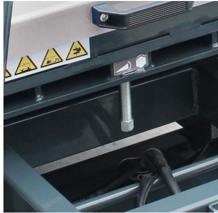
NEIGUNG DER PLATTFORM ±2° VERSTELLBAR
