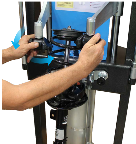
OBERE SCHWIMMKLEMMEN , ermöglichen dynamisch einen besseren Halt an der Feder Anpassung während der verschiedenen Kompressionsphasen.
