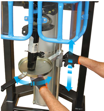
STAMMUNTERSTÜTZUNG HÖHENVERSTELLBAR 180° VERSTELLBAR
