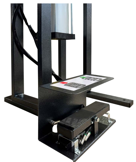
DAS FUSSPEDAL FUNKTIONIERT NUR, WENN DAS SICHERHEITSVENTIL GESCHLOSSEN IST; WENN ES GEÖFFNET IST, IST DAS FUSSPEDAL BLOCKIERT
