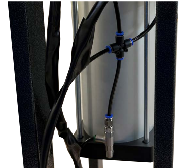
DER ZYLINDER BESTEHT AUS LEICHTMETALL UND NYLONHARZ MIT GLASFASER, um Korrosion zu vermeiden und die Oxidation der Teile der Maschine.
