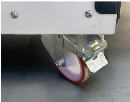
SCHWENKBARE HINTERRÄDER MIT BREMSEN
